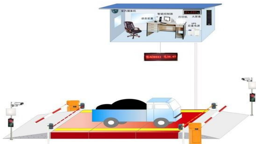
图 4-3 汽车衡无人值守称重系统
